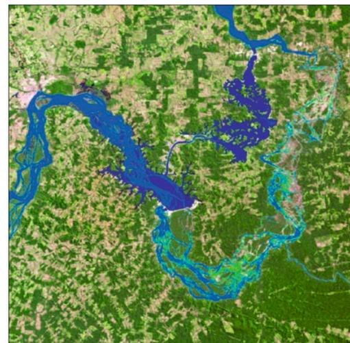
4. Der Rio Xingu bei Altamira im Echtfarben-Satellitenbild nach der Fertigstellung des Staudamms. Überlagert sind aus Satellitendaten abgeleitete neue Wasserflächen (blau) und trocken gefallene Wasserläufe (hellgrün). Daten: Sentinel-2, 28.07.2017.
