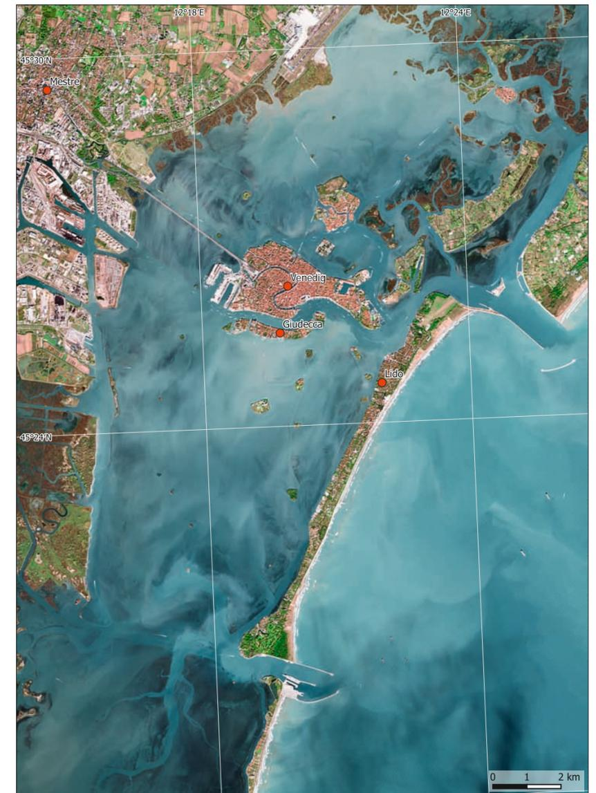
8. Venedig, Italien, bei geöffneten Barrieren von MOSE. Farbunterschiede im Meer aufgrund unterschiedlicher Sedimentkonzentrationen weisen auf Meeresströmungen hin. Daten: Sentinel-2, 04.11.2021.
