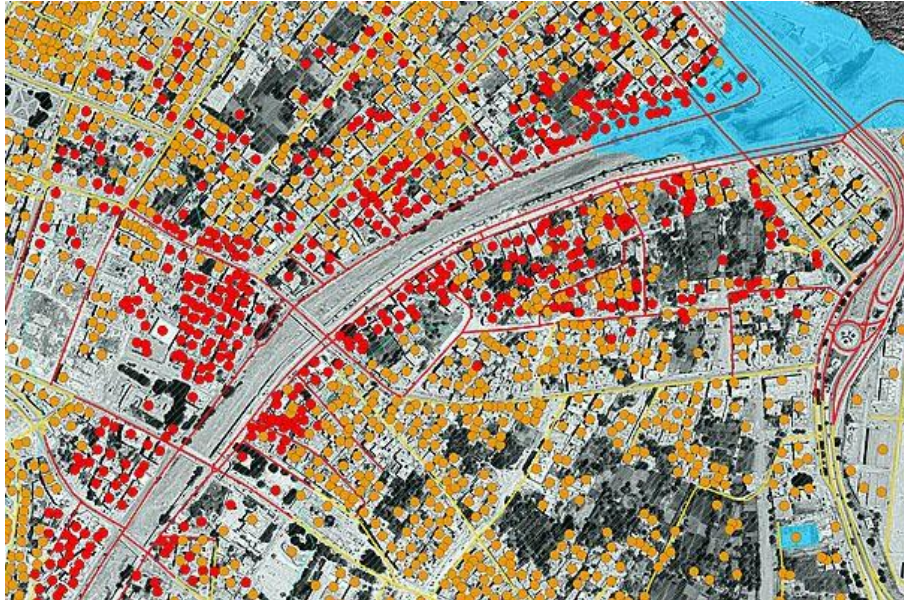
Schadensbewertungskarte des Copernicus Emergency Management Service (rot: durch das Hochwasser zerstörte Objekte, orange und gelb: beschädigt, blau: überflutet)
